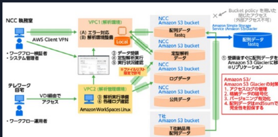
図2 セキュリティガイドラインを遵守するために作られた運用アーキテクチャ テレワークで処理を行う運用者は、VDI経由で解析環境を利用すると共に、個人情報であるゲノム情報にはアクセスできないようになっている
